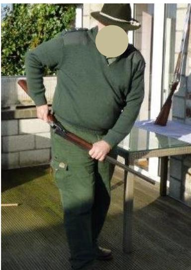
Seitlich die Unterseite der Baskule an die Hufte setzen, Verschlusshebel betatigen, die Waffe wird gebrochen, die Laue zeigen immer noch auf +/- 45° nach unten
