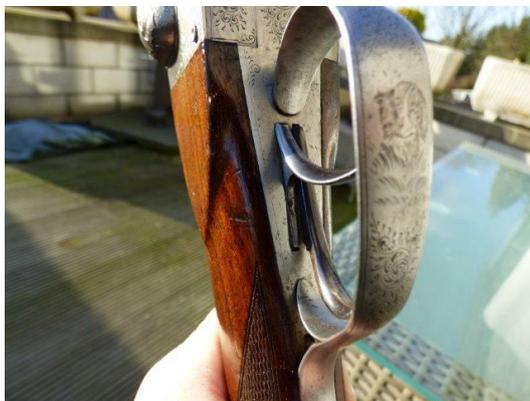
Auf diesem Foto wird sichtbar, dass die Abzüge genau wie die Läufe parallel und nebeneinander angeordnet sind.
