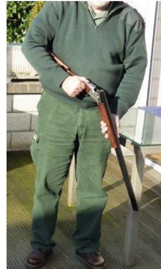
Geballte Faust seitlich an die Baskule setzen und mit dem Daum den Verschlusshebel betatigen Waffe brechen **indem der Kolben nach unten gesenkt wird**
