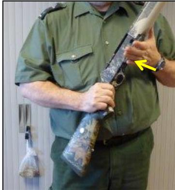
Verschlusshalterung nach unten drücken: der Verschluss schnell nach vorne und führt von selbst eine Patrone perfekt ins Patronenlager.
