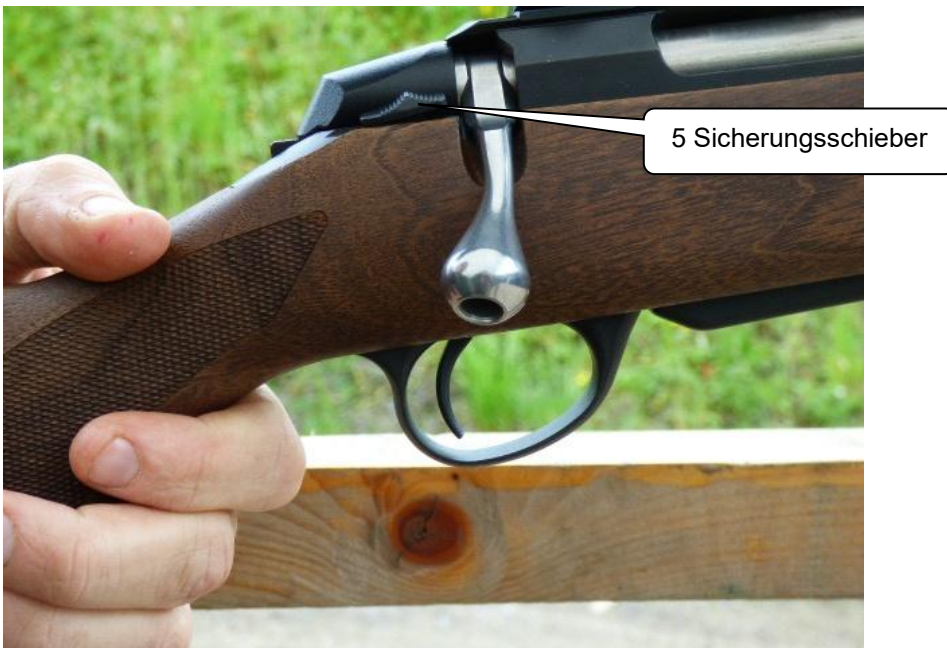
Position des Sicherungsschieber an der Prüfungswaffe
