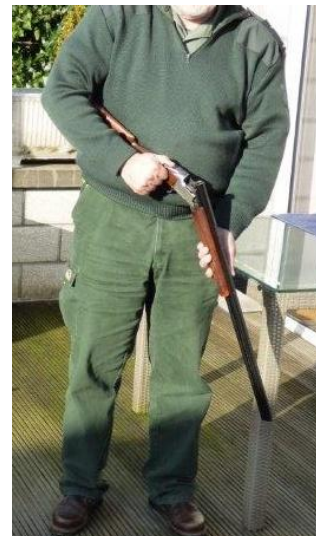
Geballte Faust seitlich an die Basküle setzen und mit dem Daumen den Verschlusshebel betätigen. Waffe brechen, indem der Kolben nach unten gesenkt wird
